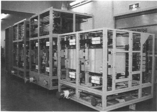
図 12 接着・リベット併用法により製造されたフレーム構造筐体
