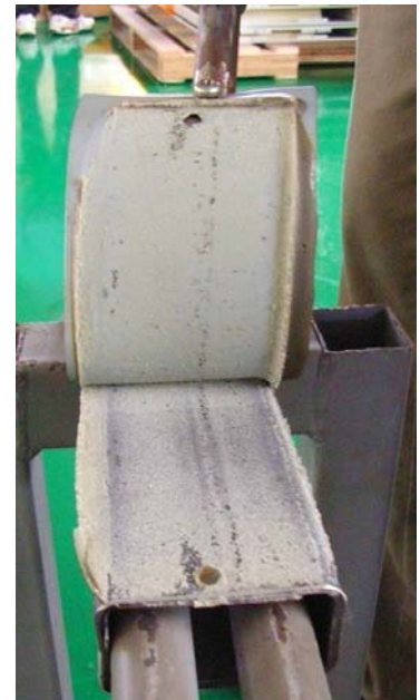
図6. 油面接着品の破壊状態(全面良好な凝集破壊)
