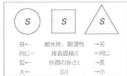
図4 接着部の形状と水分劣化性
