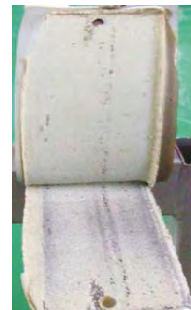
图2 冷轧钢板的油面破坏方式外观 整个面为良好的内聚破坏
