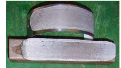
防錆油が多量に付着した鋼材と鋼板を二液型アクリル系接着剤で接着した物の破壊面の状態。完全な凝集破壊になっている。
