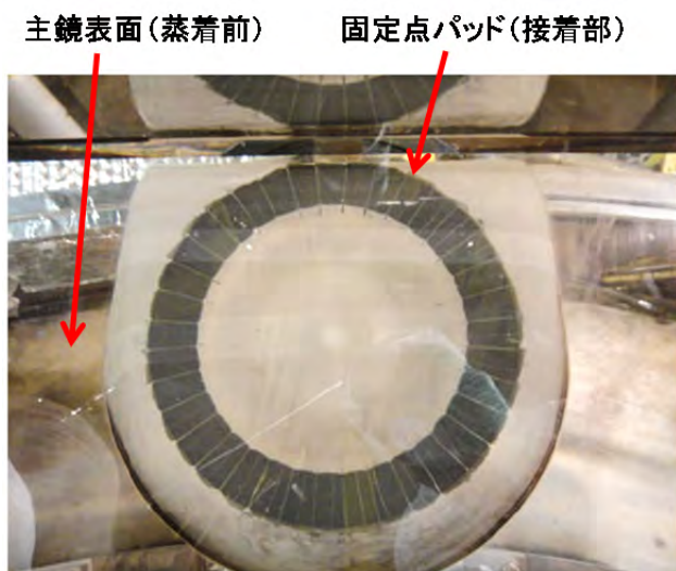
図 17. 主鏡の表側から見た固定点パッドの接着状態
