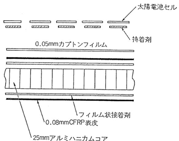
図 6. 人工衛星のソーラーアレーパネルの構成の一例
