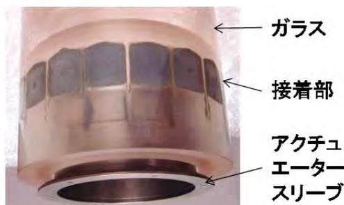
図 15. スリーブとガラスの接着試験体
