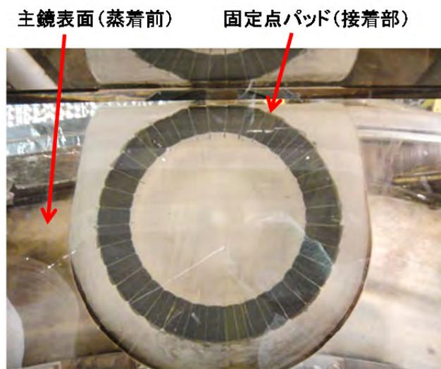
図 17. 主鏡の表側から見た固定点パッドの接着状態
