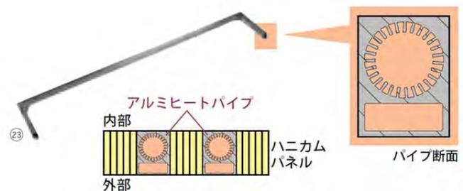
図8. ヒートパイプの形状例
